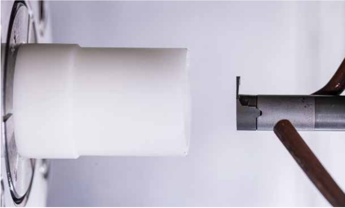
Het HORN Mini systeem wordt gebruikt voor inwendig draaien.
