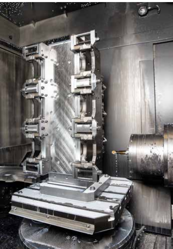
De 14 losse stukken worden op een toren geklemd voor bewerking.
