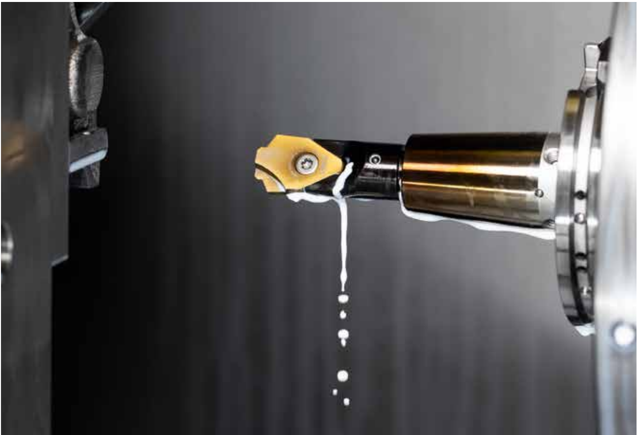
Bij gebruik boort de D117 vormboor nu het boorprofiel in één bewerking.
