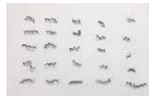
NLB Type Chipbreaker (T1500A)
