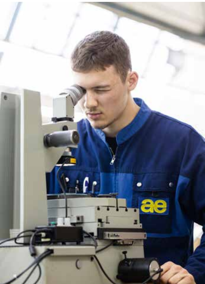
De horlogeschroeven worden gemeten onder een microscoop met een aangesloten meetsysteem.
