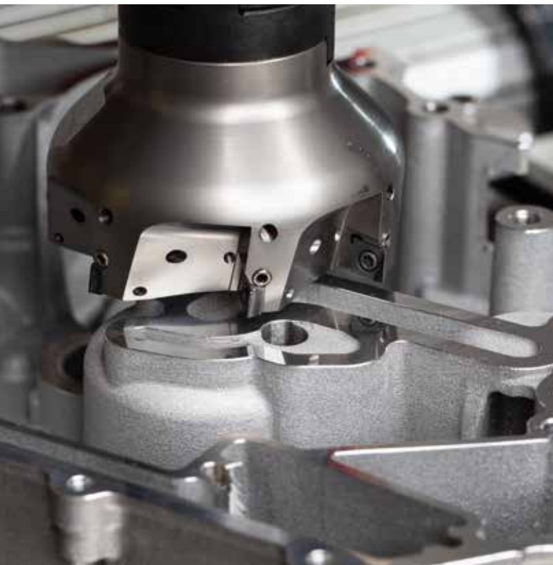
Het HORN DTM freessysteem met PCD snijplaten zorgt voor een hoge oppervlaktekwaliteit op de aluminium onderdelen.
